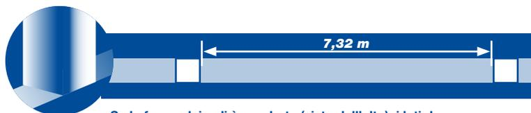
Se la forma dei pali è quadrata (vista dall'alto), i lati devono essere paralleli o perpendicolari alla linea di porta. I lati della traversa devono essere paralleli o perpendicolari al piano del terreno di gioco.
